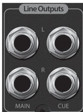
**Sorties ligne Main L/R :** la Monitor Station V2 renvoie directement aux sorties ligne Main L/R les sources audio reçues. Ces sorties tirent directement leur signal des sources d'entrée principales (Main) actuellement sélectionnées et ne sont pas affectées par le bouton de commande de niveau général ni par les touches Mono, Mute et Dim. Raccordez ces prises jacks 6,35 mm 3 points (TRS) symétriques aux entrées d'un appareil stéréo.
