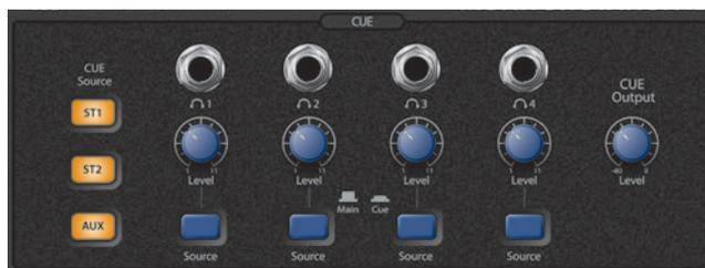
La section Cue de la face avant vous permet de gérer le système de retours de la Monitor Station V2 et de contrôler individuellement ses quatre sorties pour casque. Chaque sortie a son propre sélecteur d'entrée et sa propre commande de volume.
