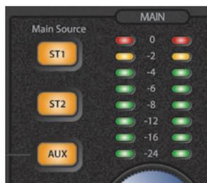
**Touches Main Source :** les touches Main Source sélectionnent le signal audio envoyé aux prises de sortie pour enceintes, aux sorties ligne Main L/R et à tout amplificateur de casque dont le sélecteur Source est en position haute (Main).
