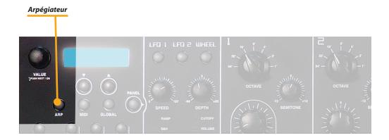
Cette fonction est un générateur automatique d'arpège en temps réel, contrôlé par quelques pages de menu claires et simples, programmables par l'utilisateur, que vous pouvez faire défiler grâce aux boutons dédiés sous l'écran alors que la commande et/ou le paramètre désiré est sélectionné par rotation de l'encodeur Value.
