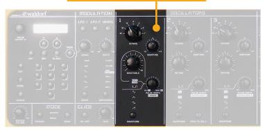
**Octave :** la plage va de 64' à 1' (7 octaves) ; veuillez noter que le registre standard d'un piano correspond à 8', ce qui signifie qu'en réglant la commande en question en position médiane, toute touche jouée sur le clavier produira la même fréquence qu'un piano standard (le clavier du Sledge va de do2 à do7 tandis que le clavier standard de 88 notes d'un piano va de la0 à do8).
