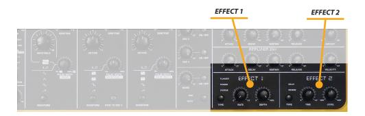
Chorus: cet effet chaud et riche est produit au moyen de filtres en peigne qui créent des copies légèrement désaccordées du signal d'entrée et les mélangent dans le signal de sortie. Le résultat ressemble à un ensemble de plusieurs sons simultanés, comme un chœur, par opposition à une seule voix, d'où le nom anglais de Chorus. Le désaccord est généré par un LFO interne dont la vitesse (Rate) et l'ampleur d'action (Depth) peuvent être contrôlés par les boutons prévus à cet effet en face avant.
