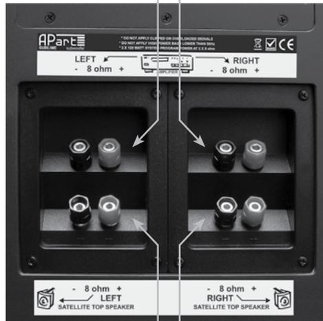
Verbinden Sie den linken Satelliten-Lautsprecher (MASK2) mit dem linken Ausgang des Sublime Subwoofers.
