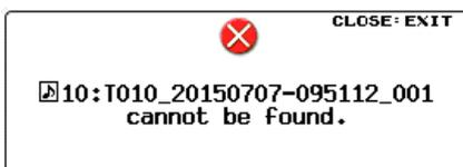
*Um den Fehler zu beheben und die Anzeige der Fehlermeldung zu verhindern, entfernen Sie diesen Take von der SSD/HDD.*
