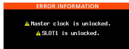
Fehler bei der Synchronisation mit der Masterclock sowie Probleme mit den Kartenschächten **SLOT 1** und **SLOT 2** werden auf diese Weise angezeigt.
