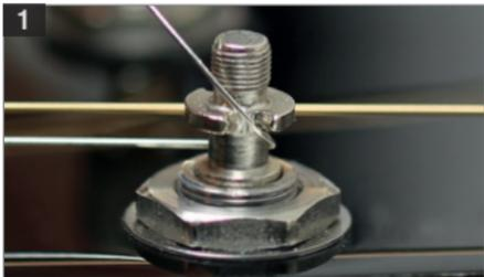
Zunächst die Sicherungsmutter abschrauben und sicherstellen das die Einkerbung der Saitenplatte ca. 90 Grad zur Längsrichtung des Halses steht.
