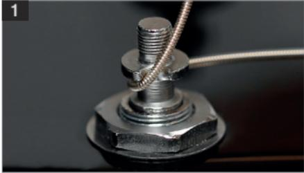
1 Zunächst die Sicherungsmutter abschrauben und sicherstellen das die Einkerbung der Saitenplatte ca. 90 Grad zur Längsrichtung des Halses steht. Dazu kann der Wirbel manuell oder im Saiten Auf- und Abziehmodus gedreht werden.
