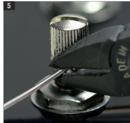
5 Das Ende der Saite nahe an der Achse abschneiden.
