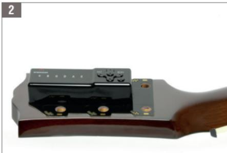
Die Elektronikplatte auf der Rückseite der Kopfplatte platzieren. Das Tronical Logo muss nach oben ausgerichtet sein.
