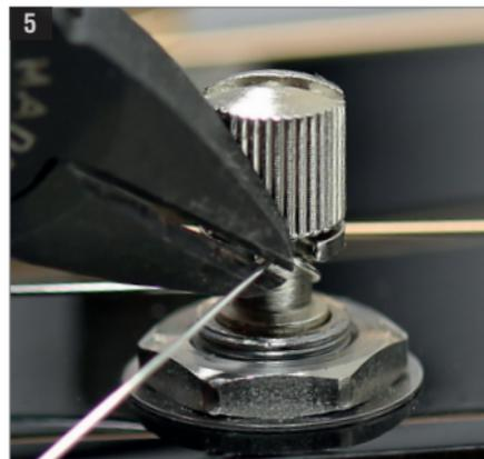
Das Ende der Saite nahe an der Achse abschneiden.
