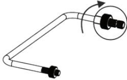
Desserrez les écrous aux extrémités de la poignée fournie jusqu'à ce qu'un espace apparaisse.
