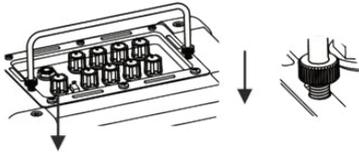
Introduisez les extrémités de la poignée dans les orifices prévus à cet effet (21) sur le dessus de l'appareil.
