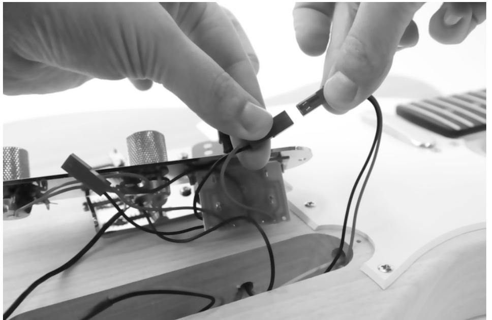
Placez le support de la prise de sortie et contrôlez le dépassement de celle-ci. La prise doit dépasser du support de façon à ce qu'elle puisse être suffisamment vissée avec l'écrou fourni et ne dépasse que d'une distance minimale. Si nécessaire, corrigez le dépassement en tournant le contre-écrou intérieur.
