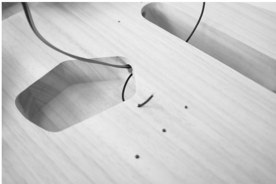
Posez le corps sur une surface de travail adaptée. Utilisez un support souple pour éviter d'endommager la surface. Insérez le chevalet avec le micro comme le montre l'illustration dans le fraisage du corps.
