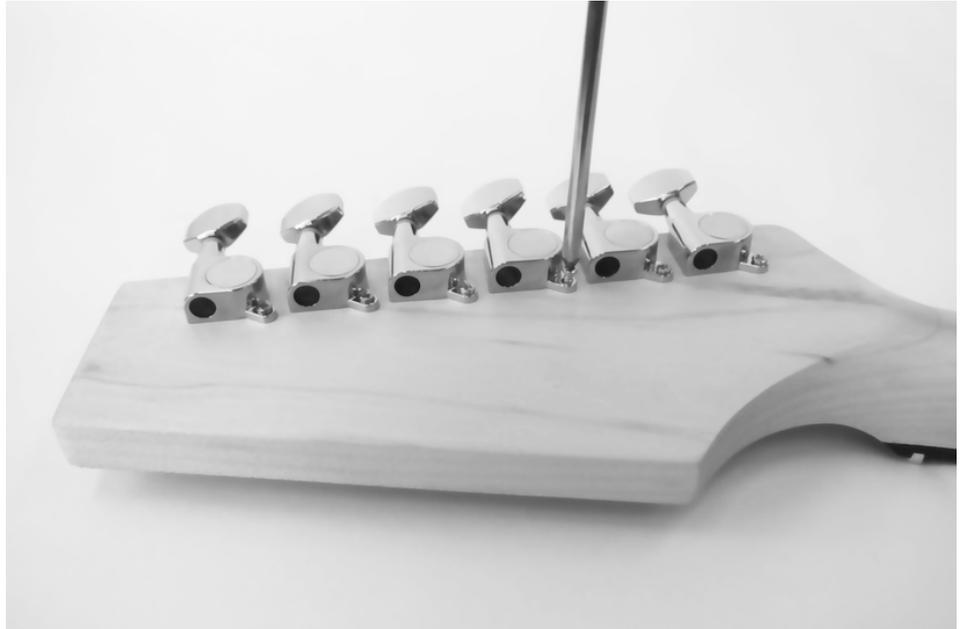
Retournez le manche et fixez tous les mécanismes d'accordage à la main sur la face avant de la tête à l'aide des rondelles et des écrous fournis.
