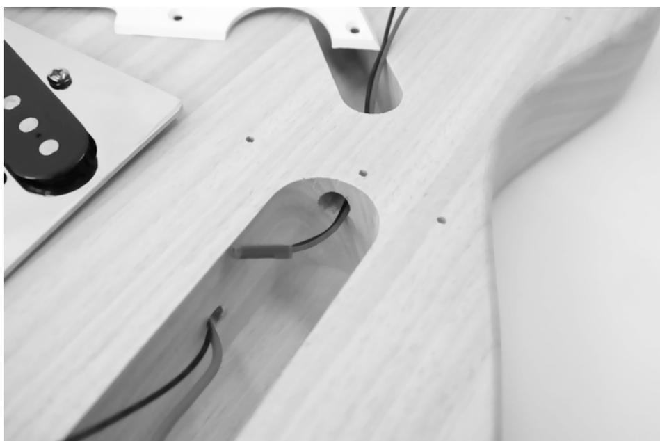
Placez le pickguard sur la partie avant du corps de façon à ce que le micro du manche se trouve dans l'ouverture prévue à cet effet. Vissez le pickguard au corps comme indiqué sur l'illustration suivante à l'aide des vis fournies.
