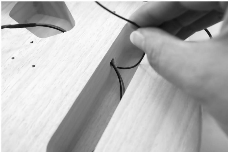
Sortez ensuite le câble par l'alésage jusqu'à obtenir un contact suffisant avec la surface métallique lors du montage du chevalet. La mise à la terre des cordes permet de réduire les bruits parasites.
