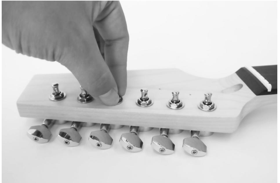
Serrez les écrous sur la face avant avec une clé adaptée, puis les vis de fixation des mécanismes sur la face arrière.
