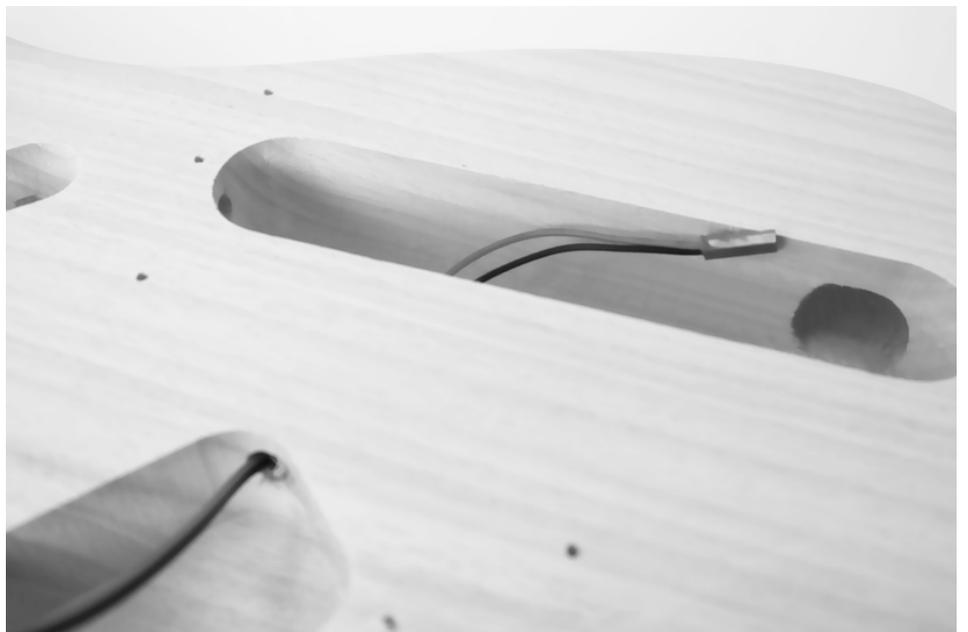
Introduisez le câble de mise à la terre des cordes (dénudé, sans connecteur) via la conduite pour le faire passer par l'ouverture du potentiomètre jusqu'à l'ouverture destinée au micro du chevalet.
