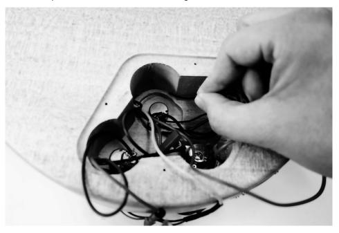
Sortez le câble par l'alésage jusqu'à obtenir un contact suffisant avec la surface métallique lors du montage du cordier. La mise à la terre des cordes permet de réduire les bruits parasites (ronflement).
