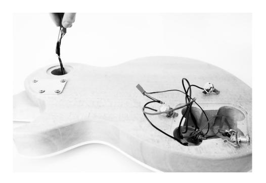
Insérez ensuite le potentiomètre dans l'ouverture arrière tel qu'indiqué sur l'illustration suivante.
