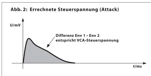
Der Einschwingvorgang jedes Audiosignals wird bei positiven ATTACK-Werten verstärkt und bei negativen ATTACK-Werten abgeschwächt.
