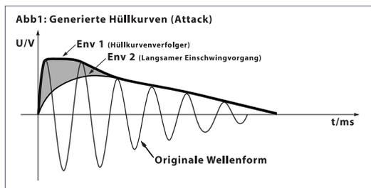
Die schraffierte Fläche ist die Differenz aus Env 1 und Env 2 (Abb.2) aus der das Steuersignal für das VCA (THAT 2181) errechnet wird.
