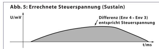
Bei positiven SUSTAIN-Werten wird der Ausschwingvorgang verlängert, bei negativen SUSTAIN-Werten wird der Ausschwingvorgang verkürzt.
