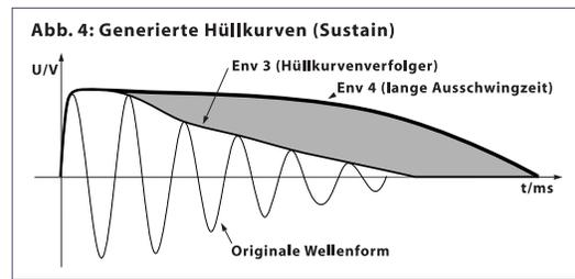
Aus der Differenz der beiden Spannungen (schraffierte Fläche) wird die Steuerspannung für das VCA gewonnen.
