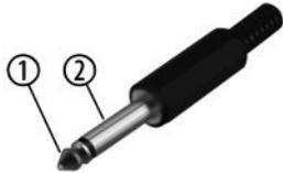
Le dessin et le tableau montrent le brochage de la fiche jack en 6,35 mm (mono) à utiliser pour l'entrée (INPUT) et pour l'entrée microphone (MIC IN).
