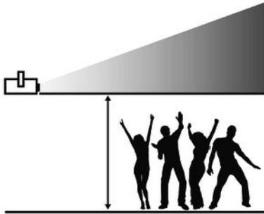
Lors de l'installation, respectez la hauteur minimale applicable pour garantir la sécurité des personnes et respectez les valeurs limites de rayonnement maximal de l'œil ou de la peau avec un laser.
