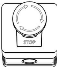
Branchez l'interrupteur externe de sécurité (non compris dans la livraison) à la prise de connexion de l'appareil prévue à cet effet. En appuyant sur l'interrupteur, le faisceau laser se coupe immédiatement.
