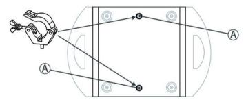
A Orifices de fixation rapide pour adaptateurs oméga
