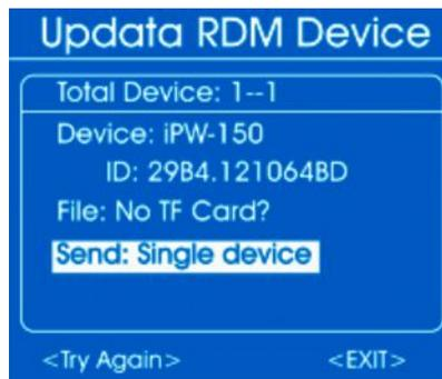
5. ➤ Pour appeler un paramètre, sélectionnez-le avec la molette jog et appuyez sur la molette jog. Sélectionnez « *Single device* » (transmission à un appareil) ou « *All devices* » (transmission à tous les appareils) et appuyez sur la molette jog.
