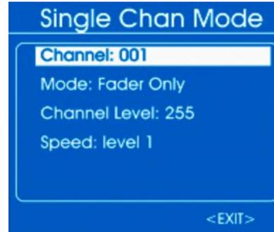
5. ➤ Pour sélectionner le canal par lequel les données doivent être envoyées, sélectionnez le point « *Channel* ». Appuyez sur la molette jog. Avec la molette jog, réglez une valeur entre 1 et 512 ou « *Tout* » pour une transmission à tous les canaux.
