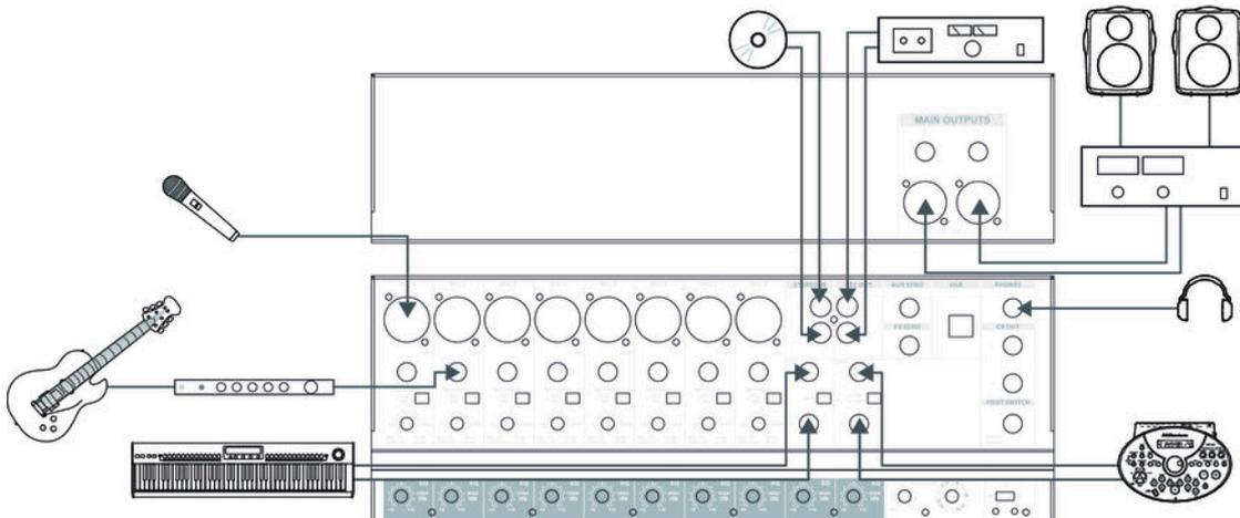
Exemple de raccordement – Homerecording avec PC
