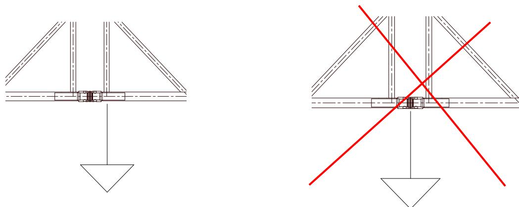
Alle Lasten sind gleichmäßig auf die Gurte zu verteilen.
