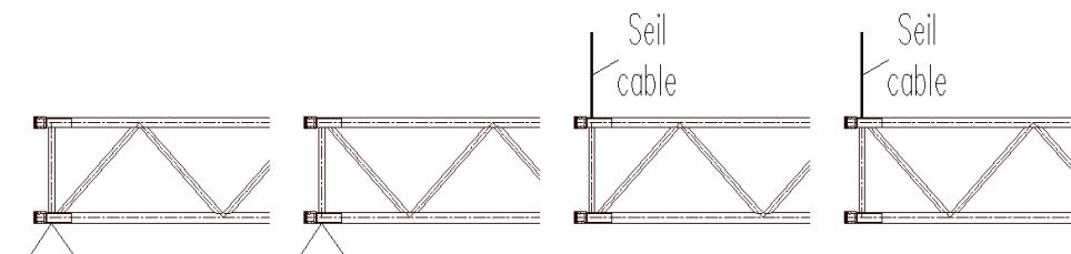
Bei Einschränkung der Position der Kupplung (siehe Kapitel 4, Fall 2), ist die Kupplung so anzurordnen, dass sie von der Lasteinleitungsstelle aus gesehen  $\geq 1,0$  m in Richtung des Auflagers liegt.
