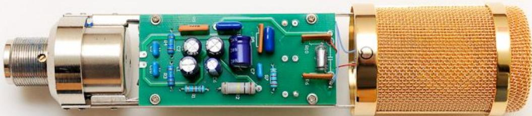
Fakt ist jedoch, dass die Röhre genau so klar (das ist meine Definition für "kalt") klingen kann, wie ein Transistor- oder Operationsverstärker. Gerade bei Röhrenmikros wird die Röhre so sanft angefahren, dass sie sehr linear verstärkt und dem Signal auch keine nennenswerten Obertöne hinzufügt.
