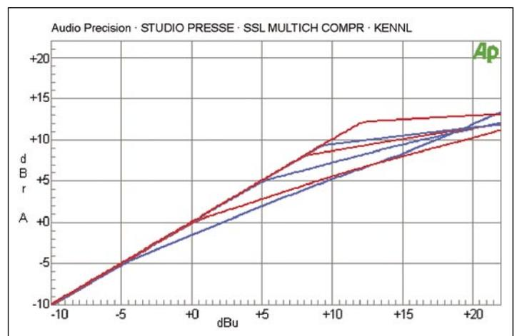
Diagramm 12: Multichannel Compressor: Kennlinien mit allen sechs Ratio-Einstellungen
