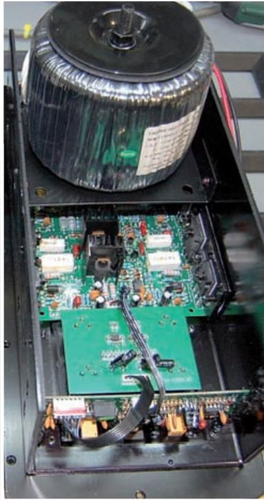
Endstufe (links) und Anschlussfeld des The Box TA-18 Subwoofers
