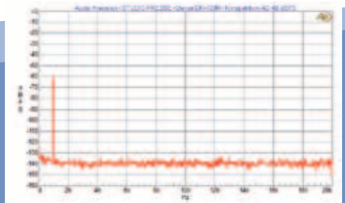
Diagramm 5: Klirrspektrum des A/D-Wandlers bei -60 dBFS Aussteuerung
