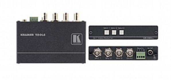
Der Kramer **VS-33Vxl** ist ein High-Performance Umschalter für Composite-Video Signale. Die Schaltvorgänge erfolgen während der Vertikal-Austastlücke, wodurch ein störungsfreies Umschalten bei synchrongetakteten Signalquellen gewährleistet ist.
