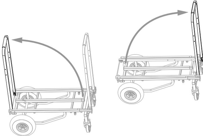
Lockern Sie zum Verlängern der Ladefläche die beiden Handschrauben unten am Rahmen. Ziehen Sie die Stahlrohrkonstruktion auf die gewünschte Länge aus und ziehen Sie die beiden Handschrauben wieder an. In der maximal möglichen Länge wird die Stahlrohrkonstruktion automatisch mit einem Rastbolzen gesichert. Um die Ladefläche aus der maximalen Auszugslänge wieder zu verkürzen, muss zum Entrasten der Sicherungsknopf an der Mittelstrebe eingedrückt werden.
