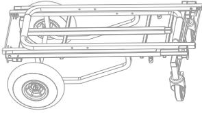
Treten Sie zum Entriegeln und Ausklappen der beiden Bügel vorsichtig auf das jeweilige Stahlseil.
