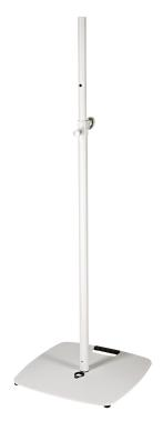
Attraktives Leuchtenstativ. Dank der schweren, flachen Stahlplatte ist das Stativ bestens für den Einsatz bei geringem Platzbedarf geeignet. Der bewährte Rastbolzen mit der Sicherungsschraube ermöglicht eine komfortable und sichere Höhenverstellung. Das Stativ hat eine max. Auszugshöhe von 2.400 mm und ist bis zu 18 kg belastbar. Die integrierte Gewindebuchse M10 ermöglicht die Befestigung einer Traverse.
