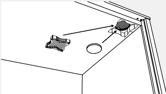
Legen Sie den Schaumfilter in die Öffnung der Isolation Booth und befestigen Sie die Lüftungsabdeckung mit vier Schrauben.
