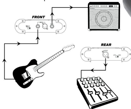
Dieses Gerät dient zur Impedanzwandlung und Symmetrierung der Signale von Musikinstrumenten mit elektromagnetischen Tonabnehmern. Jede andere Verwendung sowie die Verwendung unter anderen Betriebsbedingungen gelten als nicht bestimmungsgemäß und können zu Personen- oder Sachschäden führen. Für Schäden, die aus nicht bestimmungsgemäßem Gebrauch entstehen, wird keine Haftung übernommen.
